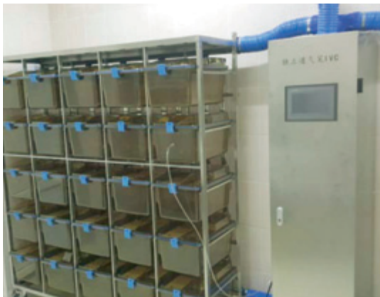
Система индивидуально вентилируемых клеток в лаборатории микробиологии ООО «Институт доклинических исследований»
