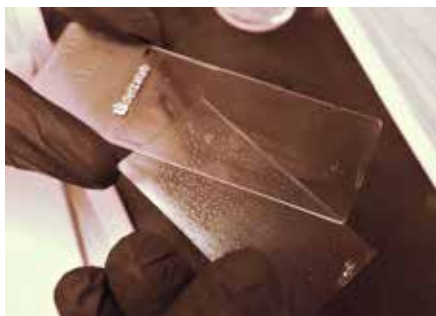
Рис. 2. Удаление покровного стекла с застывшего геля
